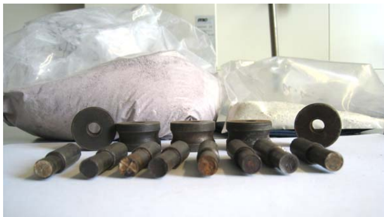
Abb. 6. Tablettierwerkzeug zum Pressen von „Party Pills“ (Vordergrund) mit sichergestellten Zubereitungen von Phenylpiperazin-Derivaten.
